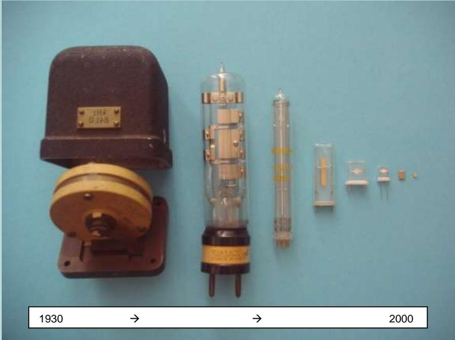
Kombinationen von Schwingquarzen mit Einzel- oder Mehrfachelektroden werden als Frequenz Filter mit hohen Gütefaktoren eingesetzt. Sie werden vor allem in Telekommunikationssystemen für die Trennung von Frequenz-Kanälen genutzt.
