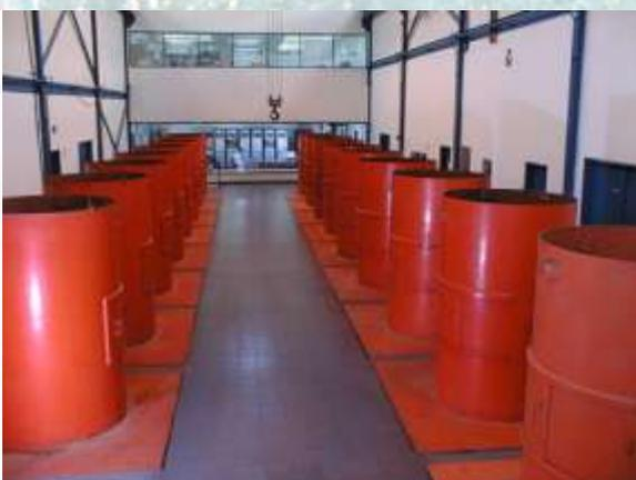
Heutige Autoklaven haben große Abmessungen, bis zu mehreren 10 Meter hoch und einem Durchmesser von mehreren Metern. Die inneren Bedingungen sind seit über 100 Jahren dieselben: ein Druck um 2000 bar und Temperaturen um die 370°C. Elektrische Heizer sorgen für die richtige Temperatur. Die Wachstumszeit schwankt zwischen mehreren Wochen und einem Jahr, abhängig von der Grösse und
